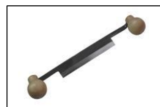
La plane (plus grossière que la rapette, elle sert à enlever une partie de l'écorce d'un arbre pour baliser.)
